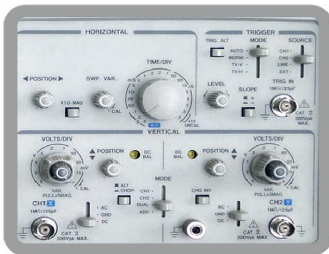
Рис. 2. Расположение ручек на передней панели осциллографа
